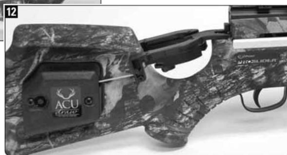
12. Арбалеты серии «6 Point»: Верните коготь в исходное положение. Не натягивайте кабель слишком туго. Держатель когтя изготовлен из закаленного металла, но может треснуть, если на него оказать слишком большое давление
