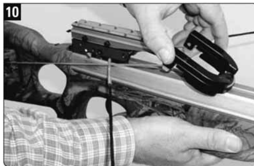
10. Как только снято напряжение с тетивы взведенного арбалета, удалите рукоятку натяжителя и вытяните коготь вперед
