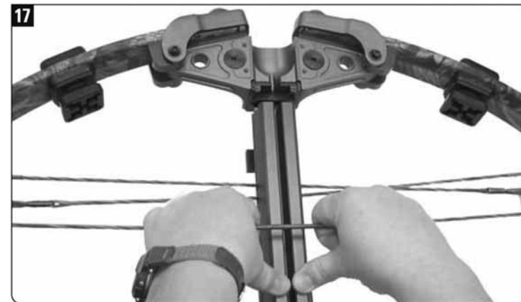
17. Мягко потяните тетиву вверх и взад, чтобы правильно посадить фронтальную часть
