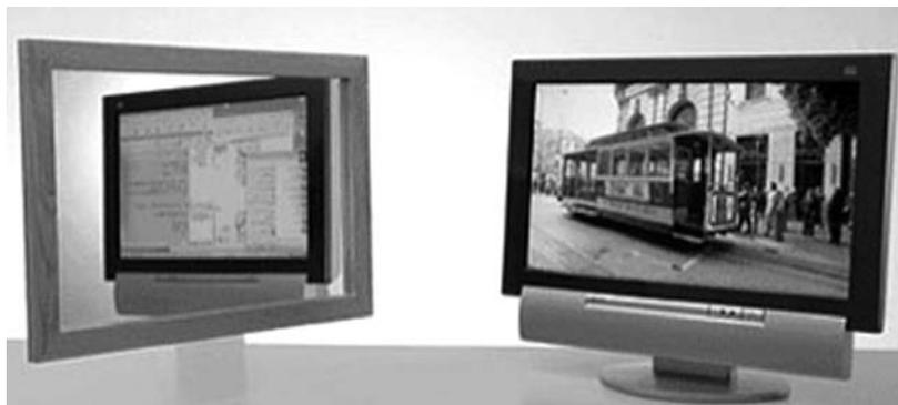
Это новшество пришло из Японии, естественно, так как речь идет о технологии изображения. Sharp разработала уникальный телевизор с тремя различными изображениями в зависимости от угла зрения. Компания-пионер жидкокристаллических экранов объявила о разработке нового типа экрана, способного отображать на экране одновременно три разных изображения в зависимости от угла зрения (слева, справа, по центру). Так, например, три человека в одной (большой) комнате смогут смот-
