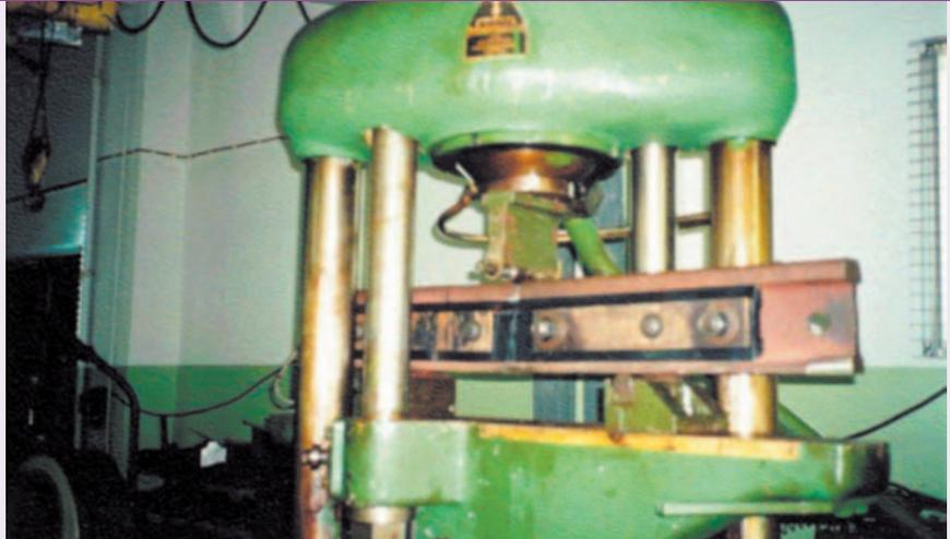
Фото 1. Стенд для испытания рельсовых накладок
