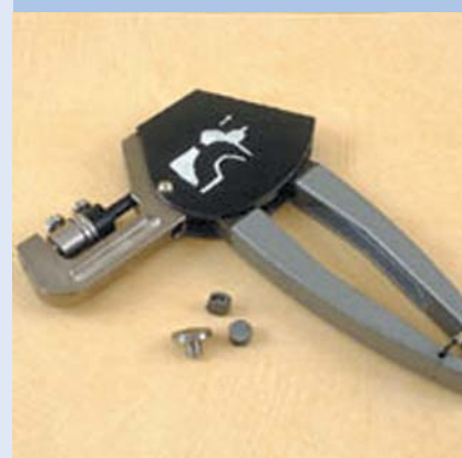
"Пломбир" - используется для постановки пластмассовых, свинцовых и жестяных пломб
